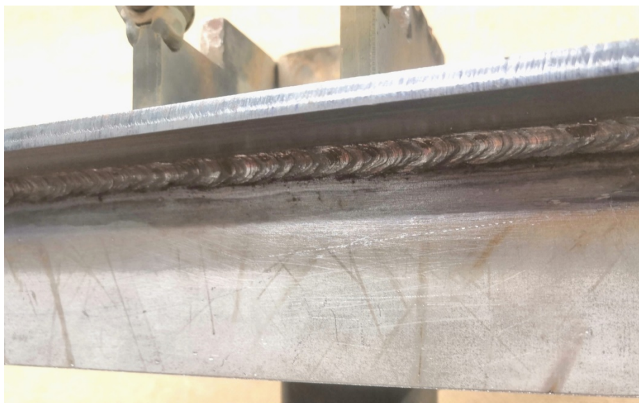
Bild 3. Kälfog under-upp med pulsad MMA (svetsläge PD). Grundmaterial 5 mm konstruktionsstål S355 och tillsatsmaterial 3,2 mm basisk elektrod. Svetsström 130 A och pulsfrekvens 1,5 Hz. Mängden sprut och stänk är minimal med tanke på typen av svetsning.
