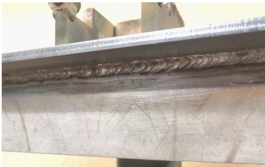
Рисунок 3. Верхний шов углового стыка, созданный путем импульсной сварки MMA (позиция сварки PD). Материал основы — 5 мм конструкционная сталь S355, присадочный материал — электрод общего значения 3,2 мм. Сварочный ток 130 А, частота импульсов 1,5 Гц. Количество брызг минимально, учитывая сварочный процесс.
