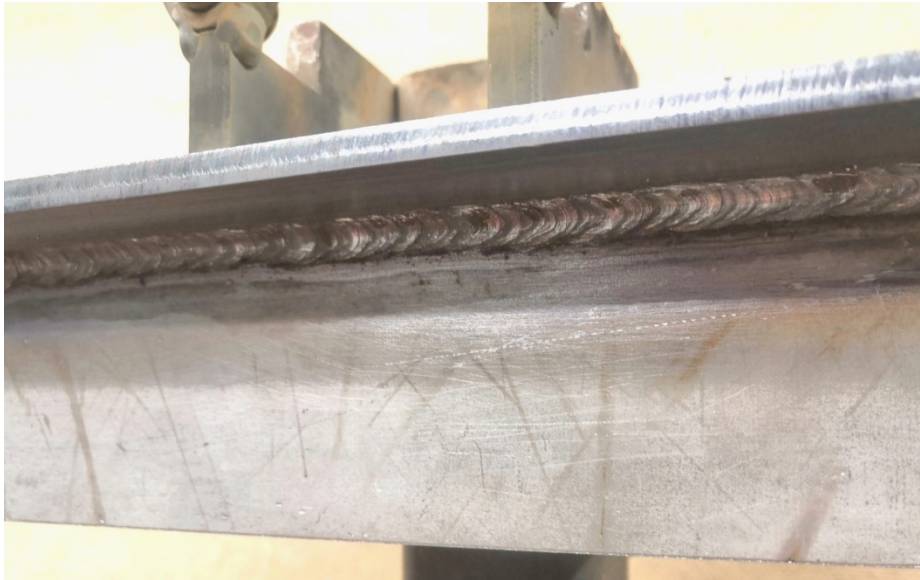
Figure 3. Soudage pulsé MMA d'une soudure en angle en hauteur (position de soudage PD). Matériau de base acier de construction S355 5 mm et matériau d'apport électrode de base 3,2 mm. Courant de soudage 130 A et fréquence d'impulsion 1,5 Hz. La quantité de projections est minime compte tenu de l'application de soudage.
