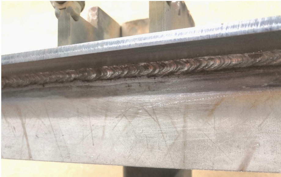
Kuva 3. Pulssipuikolla hitsattu yläpienahitsi (hitsausasento PD). Perusaine 5 mm rakenneteräs S355 ja lisäaine 3,2 mm emäspuikko. Hitsausvirta 130 A ja pulssitaajuus 1,5 Hz. Hitsaussovellukseen nähden roiskeiden määrä on vähäinen.
