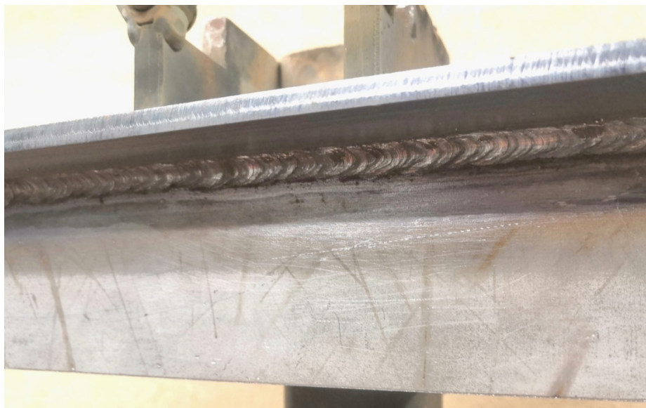
Figura 3. Soldadura MMA pulsada de filete sobre cabeza (posición de soldadura PD). Material base de 5 mm de acero estructural S355 y material de relleno de 3,2 mm de electrodo básico. Corriente de soldadura de 130 A y frecuencia de pulsado de 1,5 Hz. La cantidad de salpicaduras es mínima teniendo en cuenta la aplicación de la soldadura.
