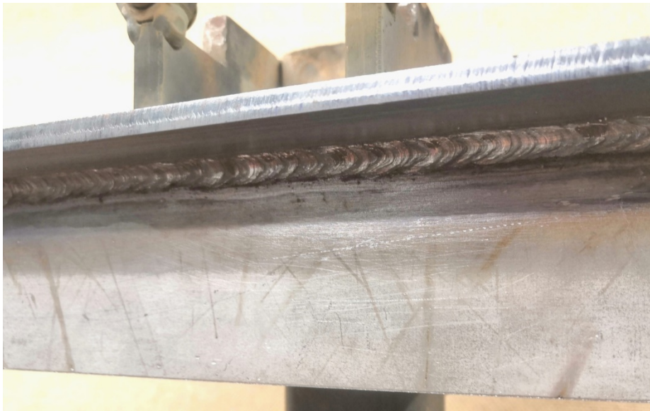
Abbildung 3. Gepulstes E-Hand-Überkopfschweißen einer Kehlnaht (Schweißposition PD). Grundwerkstoff 5 mm Baustahl S355 und Zusatzwerkstoff basische Elektrode mit 3,2 mm Durchmesser. Schweißstrom 130 A und Pulsfrequenz 1,5 Hz. Die Menge der Spritzer ist in Anbetracht der Schweißanwendung minimal.
