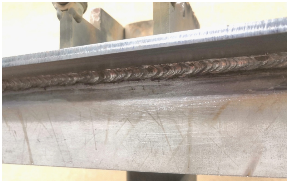
Figur 3. MMA-pulssvejet underop-kantsømssvejsning (svejsposition PD). Grundmateriale 5 mm S355-konstruktionsstål, tilsatsmateriale 3,2 mm basisk elektrode. Svejestrøm 130 A, pulsfrekvens 1,5 Hz. Mængden af svejseprøjt er minimal, opgaven taget i betragtning.
